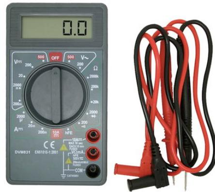
Abb. 19: Typisches Digitalmultimeter für Strom-, Spannungs-, und Widerstandsmessung, und den zugehörigen Messstrippen.
