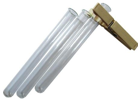
Abb. 24: Reagenzgläser in natürlicher Erscheinungsform. Die Klammer ist aus Plastik, Holz wäre besser.
