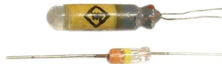
Abb. 21: Typisches Bauformen von Germaniumdioden, das Glas ist manchmal auch schwarz. Typen zum Einkauf sind im Versuch extra angegeben.
